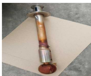
图 8 喷淋球外表面
