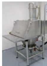
我們自製的分裝機，用於將原料藥從鋁桶或鋁袋投向料倉。
